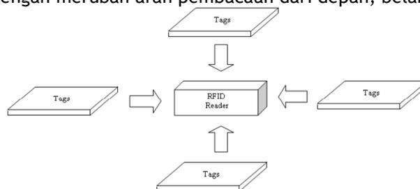
Catat jarak pembacaan pada masing-masing posisi
